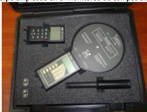
Ilustración 4 Equipo empleado en el Monitoreo de Campos Electro-magnéticos
