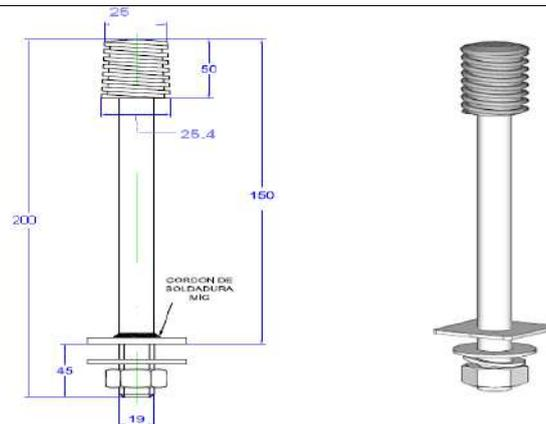
**PERNO ESPIGA (PIN) TOPE DE POSTE SIMPLE ACERO GALVANIZADO 19 mm.
