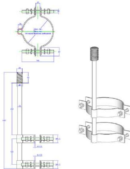
**PERNO ESPIGA (PIN) TOPE DE POSTE DOBLE DE ACERO GALVANIZADO 19 mm. DE
