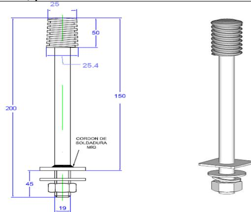
PERNO ESPIGA (PIN) TOPE DE POSTE SIMPLE ACERO GALVANIZADO 19 mm.
