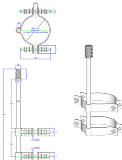
PERNO ESPIGA (PIN) TOPE DE POSTE DOBLE DE ACERO GALVANIZADO 19 mm. DE DIÁM. X 450 mm DE LONG. CON ACCESORIOS DE SUJECIÓN
