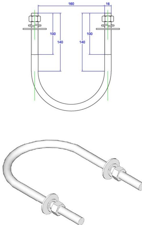
BRAZO DE ACERO GALVANIZADO TUBULAR PARA TENSOR FAROL
