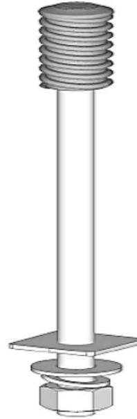
**PERNO ESPIGA (PIN) TOPE DE POSTE SIMPLE ACERO GALVANIZADO 19 mm.
