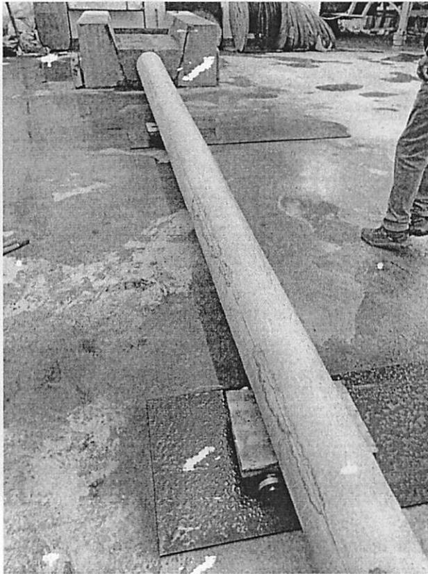
b) Verificación de fisuras posterior a la carga de 1200 kgf.
